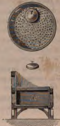
Fig. 215. — Crible pour la granulation de la poudre.
